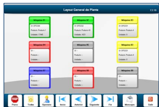
Pantalla del estado y rendimientos de las máquinas
